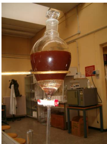
Fig. 5: Estrazione tramite solvente, si distingue la fase acquosa (scura) da quella organica (chiara)
