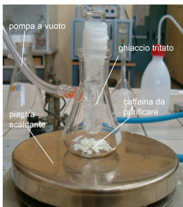
Fig. 9: L'apparecchiatura per la sublimazione.
