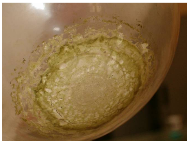
Fig. 6: Residuo solido della distillazione, le parti bianche sono formate da caffeina, quelle verdine dalle impurità, principalmente clorofilla
